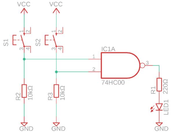
回路図では示していませんが、当然 IC の電源は供給し、使用しない入力は Vcc または GND に接続してください。
