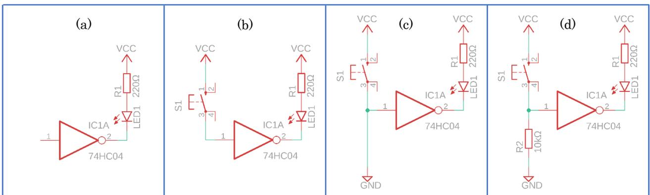
は GND に接続されていますから、L になりますね。しかし、スイッチを押した時のことを考えてみましょう。これでは、VCC と GND が抵抗もなしに直接接続されてしまい、ショートしてしまいます。では、どのようにすればよいのでしょうか。正解は(d)の回路です。
